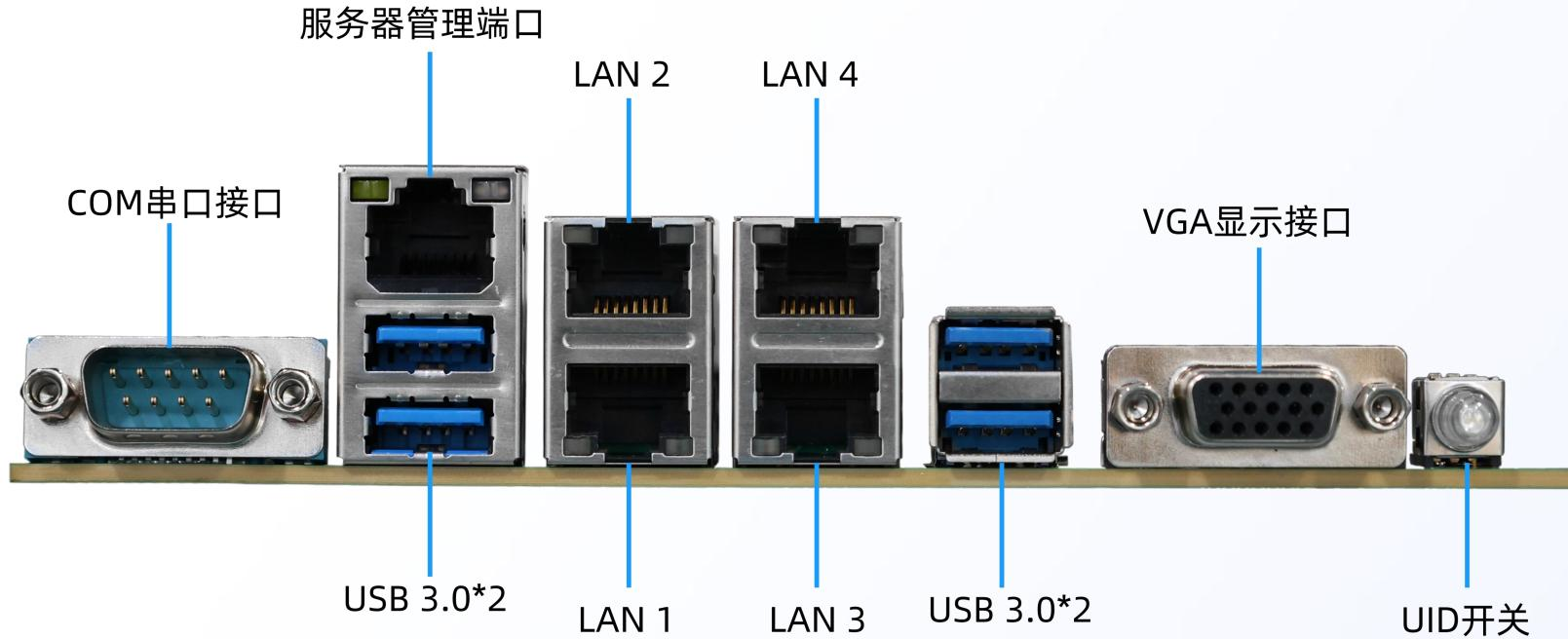
**注意：**外围设备可以直接插入这些端口中的任何一个，但可能需要软件来完成安装。
